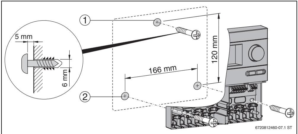
Fig. 6 Installazione a parete della centralina solare
