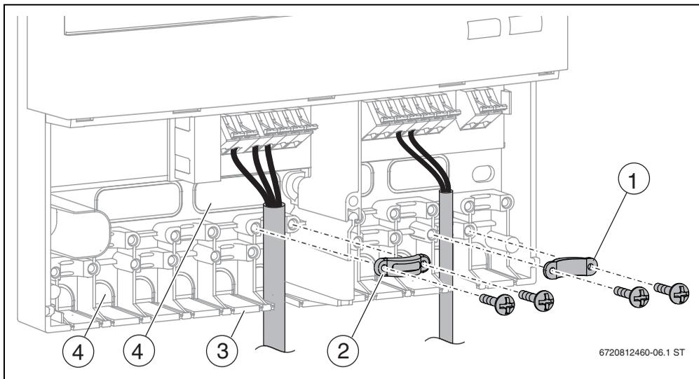
Fig. 7 Inserimento e fissaggio del cavo conduttore
